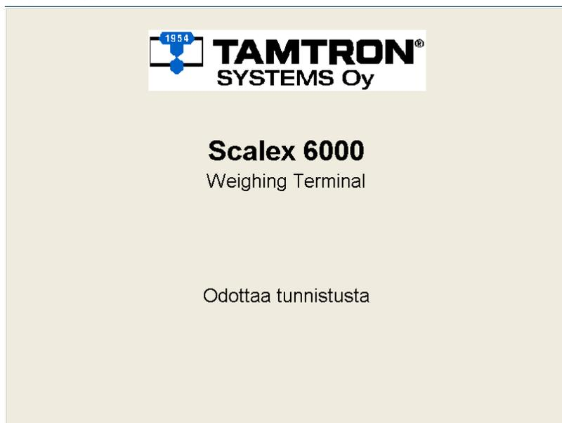
Когда автомобиль идентифицирован, на дисплее появляется номерной знак, и водитель видит в реальном масштабе времени общий вес автомобиля. Водитель может с помощью клавиатуры задать дополнительную информацию в пустом поле, и подтвердить взвешивание клавишей ENTER, после чего устройство распечатает чек.
