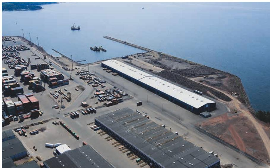
При обустройстве сектора D портового района Муссало наряду с другими материалами использовался извлеченный в процессе дноуглубления грунт, а также очищенные отходы бетона и кирпича.
